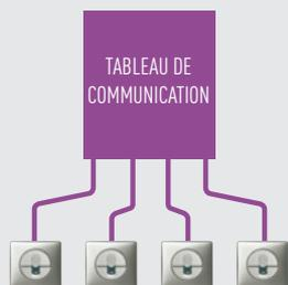
Le câblage doit être réalisé en étoile à partir du tableau de communication vers les prises de communication de type RJ 45<sup>(1)</sup>.
