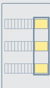
Le tableau électrique doit présenter une réserve de **20 % d'emplacements disponibles**, pour permettre une évolution de l'installation. **En logement collectif**, cette réserve est de **6 modules minimum**.
