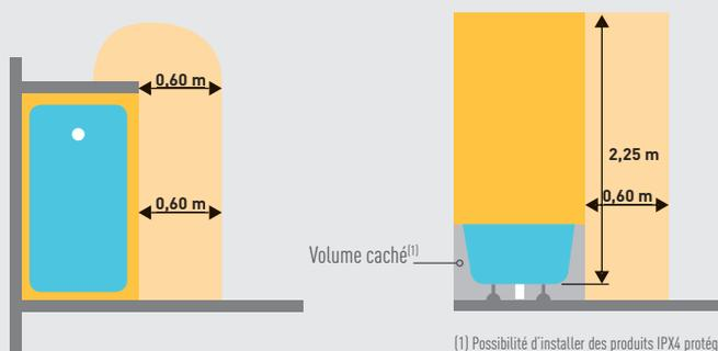
(1) Possibilité d'installer des produits IPX4 protégés par un interrupteur différentiel 30 mA. Exemple : moteur de bainé
